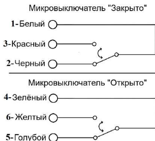
Схема контактной группы концевых выключателей УКП встроенного в редуктор
