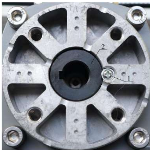
1- винт фиксирующий шлицевую втулку, 2 - шлицевая втулка
